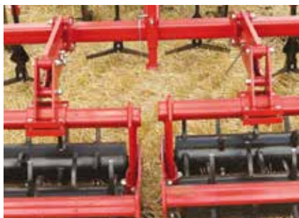
Avantajele cilindrului cu pinten cu auto-curățare
