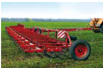
LIRA Rastras de dientes de muelle hidráulicas de área ancha de trabajo
