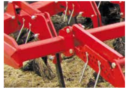
Ajuste cómodo de la profundidad de cultivo
