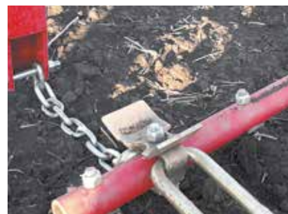
Ajuste del ángulo del diente
