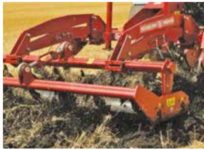
Instalação equilibradora dos rolos
