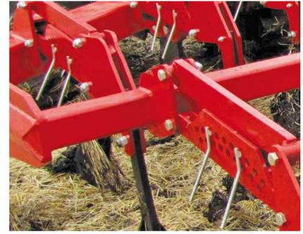
Удобная регулировка глубины обработки
