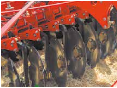
Стойки из высокопрочной стали
