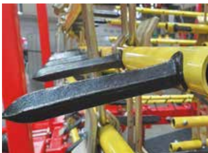
Высокопрочный ромбовидный зуб
