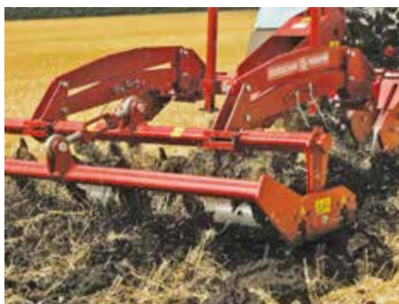
Балансирная установка сдвоенного шпорового катка
