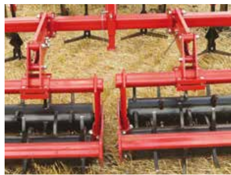
Преимущества шпорового самоочищающегося катка
