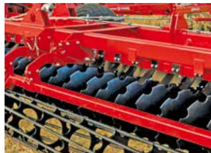
Незабывающийся прутково-клетевой каток без центральной оси
