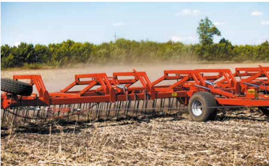
Тросовое натягивания секций
