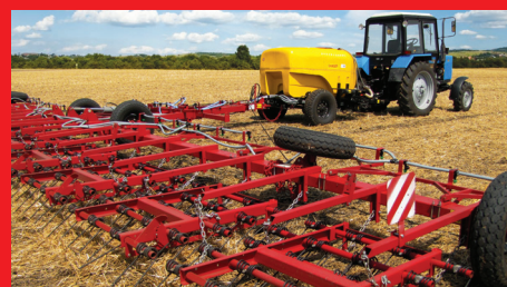
РЕАЛ За внасяне в почвата на препарати за защита на растенията и минерални торове
